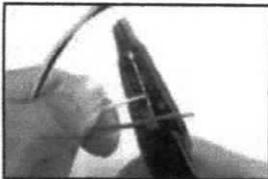
3. Stecken Sie nun die Kabelenden in die Quetschverbindungen der neuen Sonde. Achten Sie darauf, dass die Farben der Kabel übereinstimmen. Drücken Sie die Quetschverbinder mit einer Zange zusammen.
